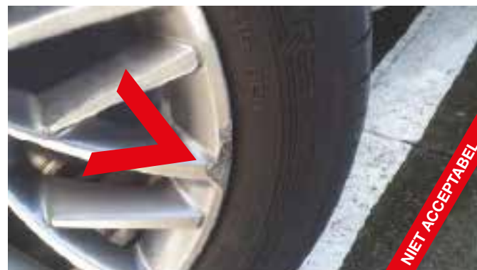
Beschadigde lichtmetalen velg
